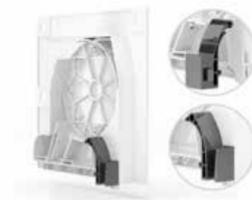
Es ist auch möglich, Einlaufstutzen ohne der notwendigen Demontage des ganzen Rollladens zu wechseln. Der Einlaufstutzen wird in den Blendenkasten in Form einer T-Verriegelung eingeführt und danach an diesem mit einer Schraube angeschraubt, was die Verbindung von allen Elementen stabilisiert. Die Stelle, an die die Schraube angeschraubt wurde, ist ästhetisch versteckt.
